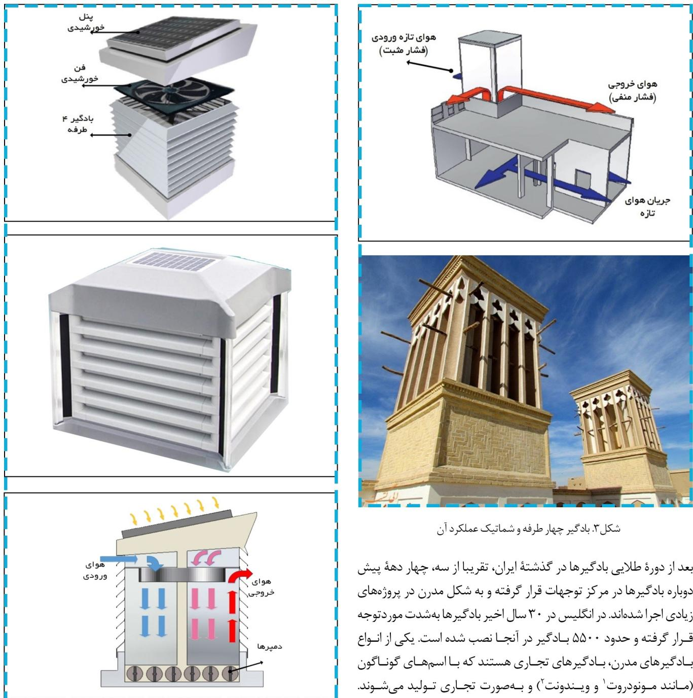
شکل ۳. بادگیر چهار طرفه و شماتیک عملکرد آن
